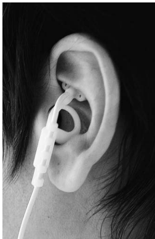
Abbildung 15 Aurikulärer Nervus-vagus-Stimulator (VITOS®; mit freundlicher Genehmigung der cerbotec GmbH)
